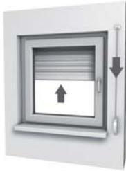
Aufzugsgurt immer **gleichmäßig und senkrecht** nach unten bzw. aus dem Wicklergehäuse ziehen.
